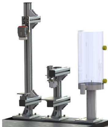
图 5 视觉称重模块、颜色分拣模块、温度模块
